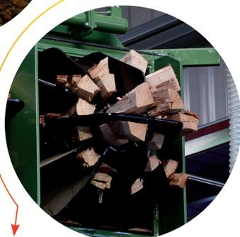
**2 Fendage :** passage des rondins dans une machine de fendage. Calibrage en petites sections de 12 cm maximum (longueur 25, 30 ou 40 cm).
